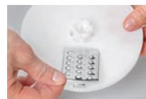
※ブレードは、直線の側がブレードディスクの中央に、円弧になった側が、ブレードディスクのふちの方にはまるようになっています。
