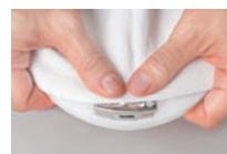
※ブレードは、両端にツメがついています。まず直線の側を中心にはめて、上からふきんをかぶせて、円弧の側を押してはめ込み、カチッと音がしたら完了です。
